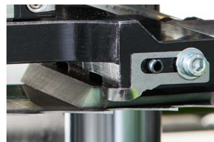
Guia de carbono de alta tecnologia extremamente resistente ao desgaste
