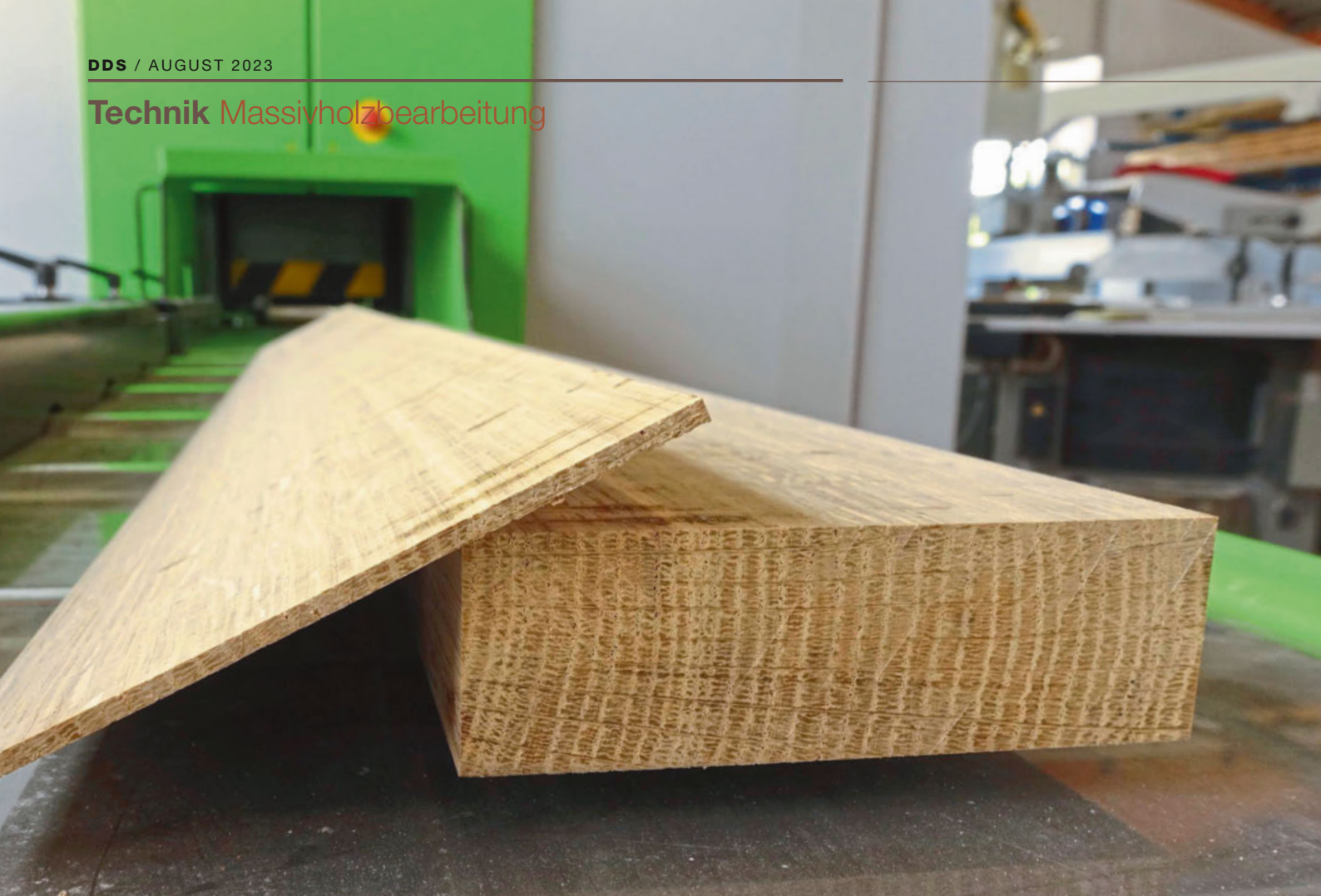
Wunschkicken ab 1,8 mm: Die Dünnschnitt-Bandsäge liefert perfekte, verleimfähige Schnitte
