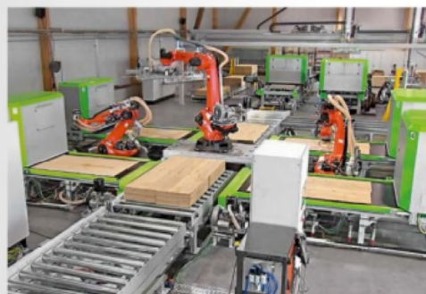
Mit der Kombianlage erzielt Wintersteiger den bestmöglichen Materialfluss bei der Ausbesserung in Parkett-, Möbel- oder Plattenproduktionen
