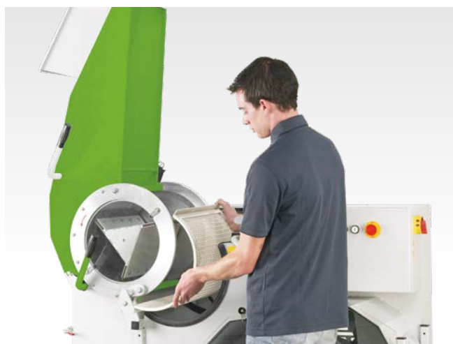
Sostituzione del contro battitore
