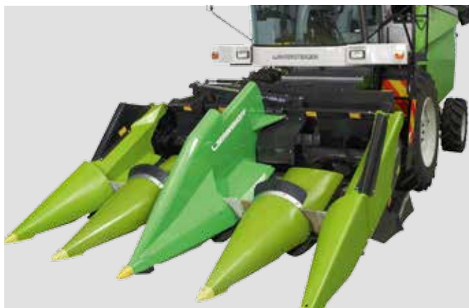
玉米割台，液压控制可折叠
