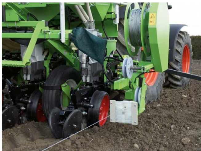
带有钢索复卷机的钢索控制系统
