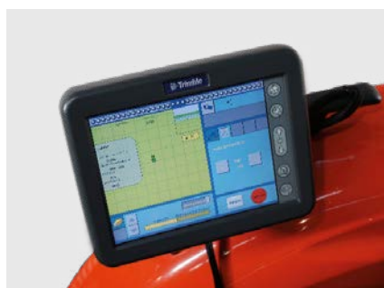
在拖拉机上安装控制屏幕
