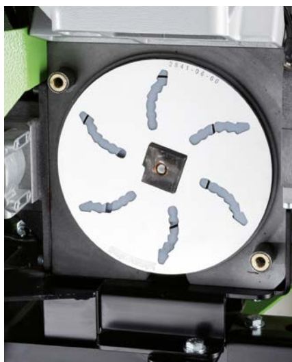
带有径向槽排种盘和位于其后的螺旋槽排种盘
