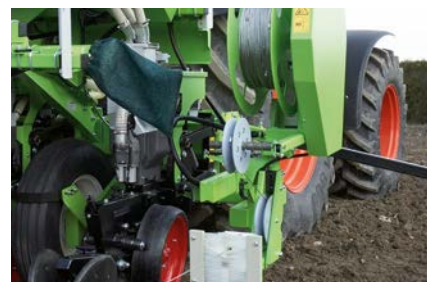
带有钢索卷复机的钢索控制系统
