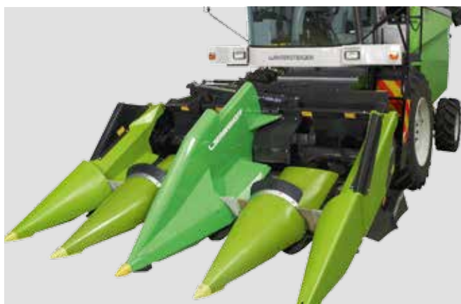
Testata per mais, con ribaltamento idraulico
