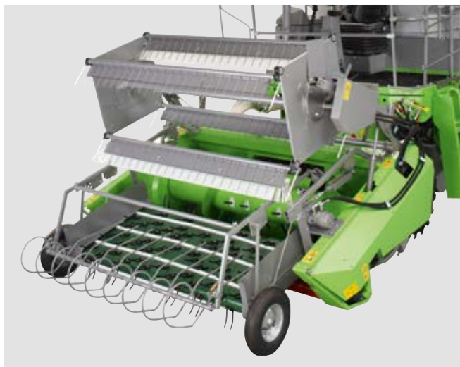
Pick-up de la moissonneuse-batteuse pour parcelles Delta
