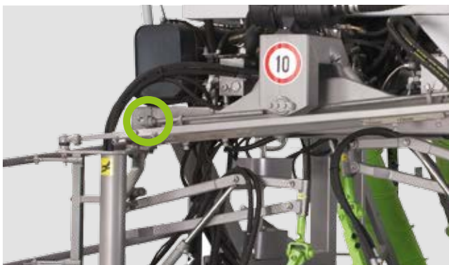
Vis de réglage pour le réglage de la largeur de voie sur l'essieu arrière
