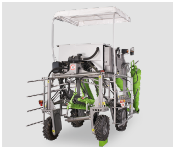
Essieu oscillant sur la suspension de roue arrière pour une adaptabilité élevée
