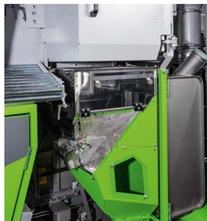
Sistema NIRS per l'analisi del raccolto
