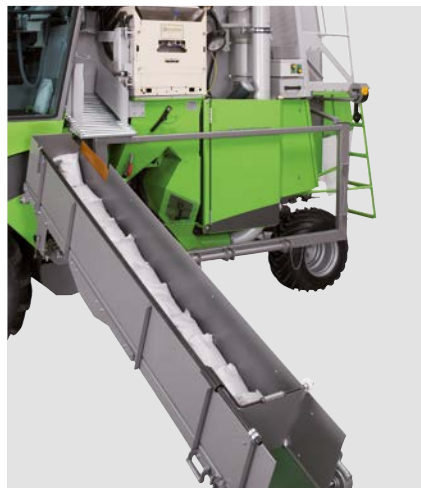
Altezza di svuotamento regolabile del nastro per trasporto campioni
