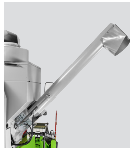
Tubo hidráulico de vaciado del depósito de granos
