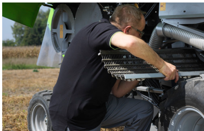
Fácil cambio de las cestas del cóncavo de trilla
