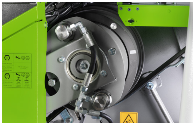
Variador del cilindro de trilla
