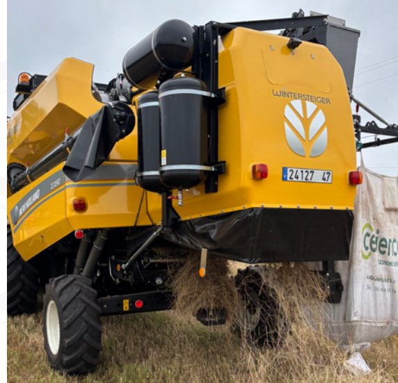
Réservoir d'air comprimé de 360 l
