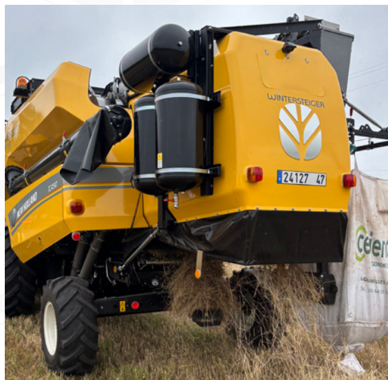
Serbatoio aria compressa da 360 l
