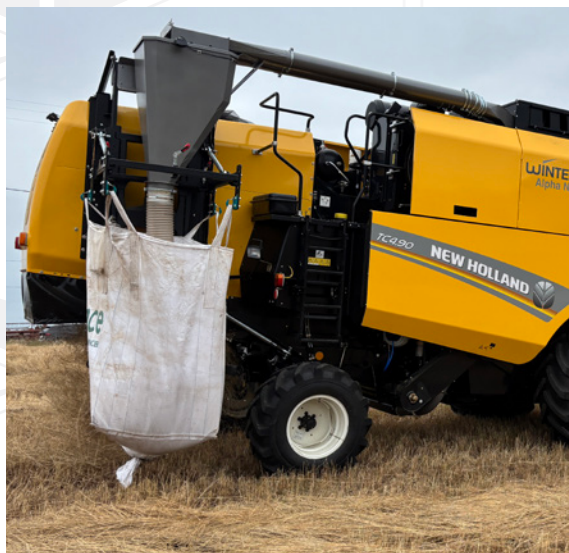
Dispositivo de enchimento de big bags
