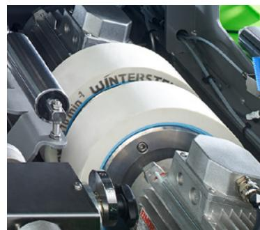
Nach dem Schleifen folgt das Polieren. Integriert im Modell Scout sdp, bringt das Polier- Modul die Kanten bis in den Schaufelbereich auf Hochglanz.
